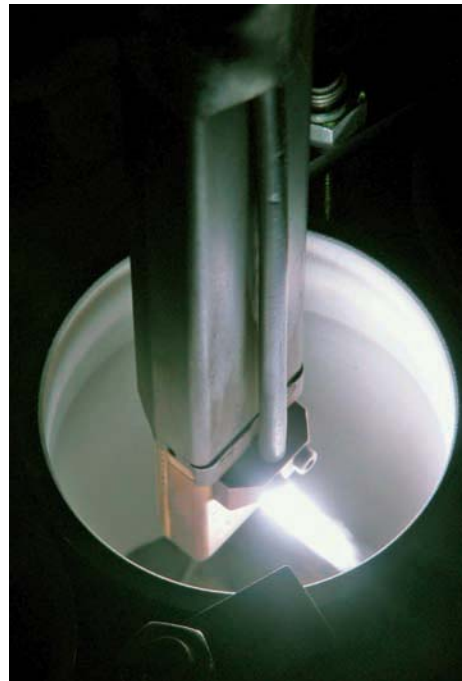
Bild 3: APS Plasma-brenner F210 von Sulzer Metco bei der Innenbeschichtung
