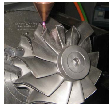
3D-Reparatur auf Turbolader-Schaufelspitzen mit MetcoClad 625
