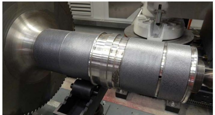
Reparatur von Wellen mit Fe-Basislegierungen
