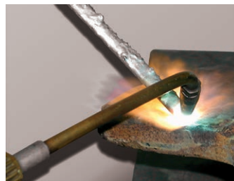
Verbundschweißstab zum autogenen Auftragsschweißen
