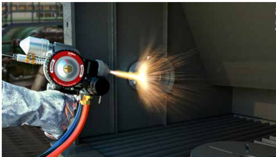
Ein Flammspritzgerät im Einsatz
