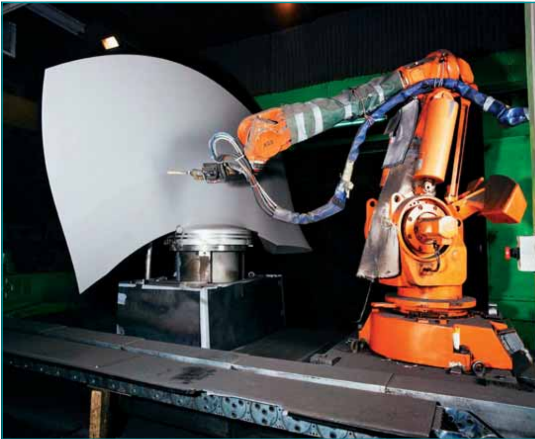
Bild 2: Schaufel einer Kaplanmaschine, beschichtet mit Metco TURB von Oerlikon Metco
