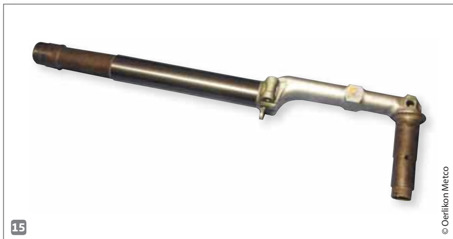
15 Nose gear of an F5 Tiger with a WC/CoCr coating. Carrello anteriore di un F5 Tiger con un rivestimento WC/CoCr.
