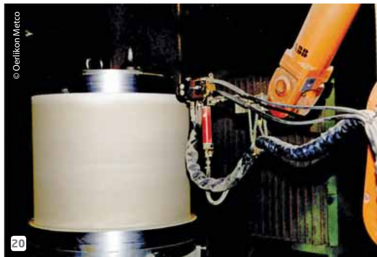
Bearing shaft with a babbitt coating. Albero di supporto con rivestimento in metallo bianco antifrizione.
