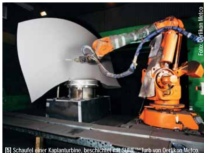
[5] Schaufel einer Kaplanturbine, beschichtet mit SIME™ Turb von Oerlikon Metco.
