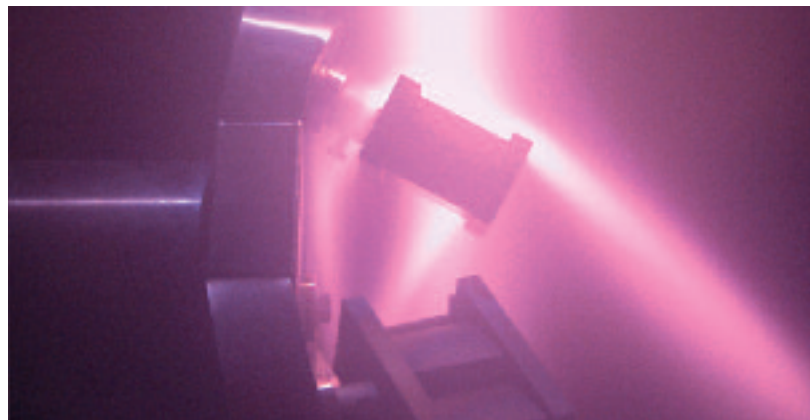
4 Demonstration der industriellen Eignung: das LPPS-Hybrid-PS-PVD-Verfahren mit Mehrfachspanneinrichtung und drei in der Spitzkammer montierten Dummy-Schaukeln.
