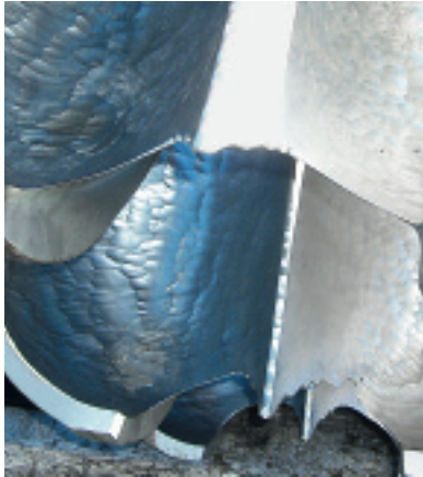
4 Verschleiß der Becher einer Pelton-turbine. (Quelle: Wikipedia).
