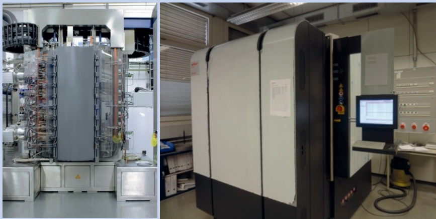
FIGURE 9 : Exemples de machines de dépôt Oerlikon Balzers utilisés pour la déposition des revêtements Balifor M. A gauche : « Oerlikon Balzers Domino XL » utilisé pour la production du MoN en grande série, comme par exemple pour les axes de piston. À droite : « Oerlikon Balzers Innova » utilisé pour la production du MoN en petite et moyenne série ainsi que pour le développement de nouveaux dépôts à base de MoN.
