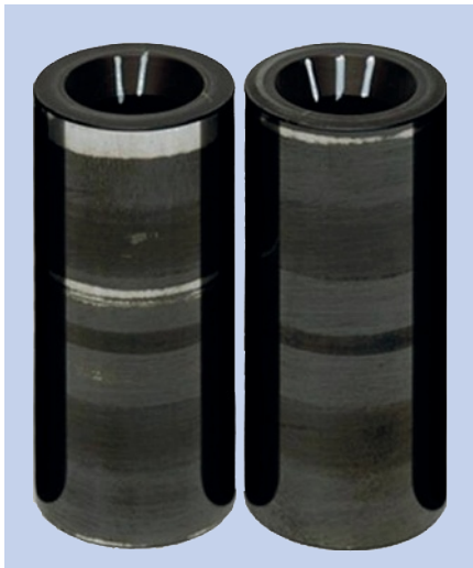
FIGURE 4 : Axes de pistons revêtus en Balinit DLC Star après test moteur. Dans les zones les plus sollicitées thermiquement et mécaniquement (proches du piston et arêtes de la bielle), la couche a-C:H est localement usée. La performance antigrippage du revêtement reste toute même assurée par les sous-couches du revêtement.
