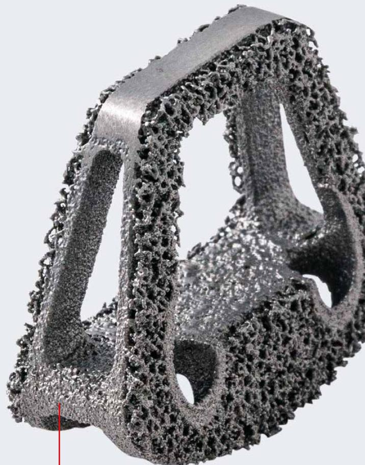
Additiv gefertigtes Wirbelsäulenimplantat mit sichtlich poröser Oberfläche für eine begünstigte Osseointegration
