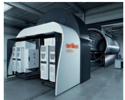
Mit Abmessungen von 10 x 3 Metern und einer Kapazität von 40 Tonnen handelt es sich bei den aktuellen PPD-Anlagen laut Oerlikon Balzers um die größten Anlagen weltweit.
