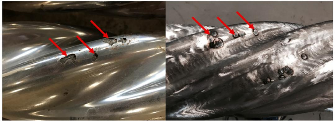
Bild 1: Bohrstrang-Spülungsrotor mit Lochfraßkorrosion (links) und nach der Reparatur durch Punktschweißen während der Aufarbeitung (rechts)
