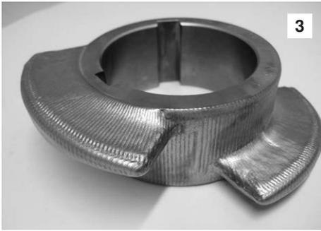
den gleichmäßigen und endformnahen Schweißaufbau wird etwaiger Nachbearbeitungsaufwand deutlich reduziert oder entfällt ganz – bei derartigen, extrem harten Werkstoffen ein grosser Vorteil.
