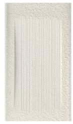
整齐切削的陶瓷可磨耗涂层 [1100°C (2012°F)时] 示例。 左图:不镶刃叶片,右图:cBN镶刃叶片
