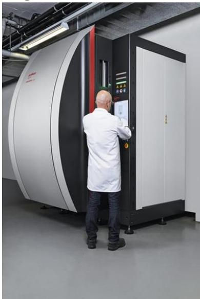
A utilização de recursos para um revestimento PVD em tais equipamentos é de apenas cerca de 10% em comparação com a fabricação de uma nova ferramenta de metal duro. Foto de : Oerlikon
