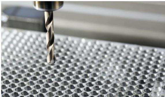
Uma broca sem revestimento produz 28 furos, enquanto uma com revestimento BALINIT PERTURA produz mais de 4.500. Este notável aumento de 160 vezes na vida útil não só economiza 13,7 kg de metal duro, mas também o equivalente a 75 faias, que absorvem aproximadamente 935 kg de CO<sub>2</sub> por ano. Foto de : Oerlikon
