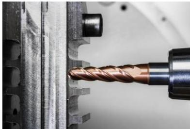
O revestimento PVD BALINIT TISAFLEX da Oerlikon Balzers aumenta a vida útil da ferramenta em 14% em comparação com produtos de referência anteriores na usinagem de Inconel, criando assim benefícios ecológicos significativos. Foto de : Oerlikon
