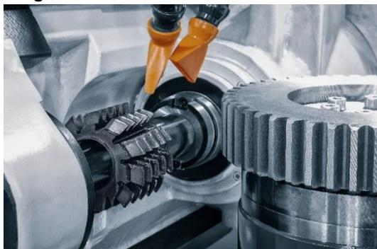
A vida útil da ferramenta aumentou em mais de 40%: BALINIT ALCRONA EVO já impressionou em um teste realizado por um fornecedor Tier1 da indústria automotiva na fabricação de caixas de engrenagens com fresas de corte. Imagem: AdobeStock
