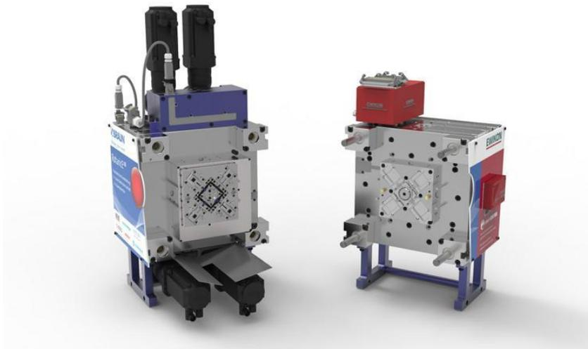
Um excelente exemplo de design compacto e eficiência: a tecnologia patenteada de molde de injeção RotaricE<sup>2</sup>® da Braunform, visualiza-se aqui na forma de um molde de injeção 4+4 para produzir conectores Luer / Imagem: Braunform
