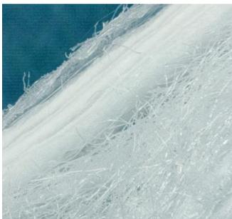
**Bildunterschrift:** Bei einer Atemschutzmaske der Schutzklassen FFP1 bis FFP3 spielt das eingearbeitete Vlies die entscheidende Rolle.
