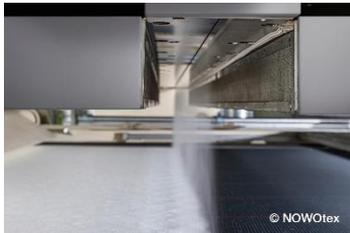
**Bildunterschrift:** Der Meltblown Spinnprozess von Oerlikon Nonwoven besteht durch besonders homogene Vlieseigenschaften und Flächengewichte.
