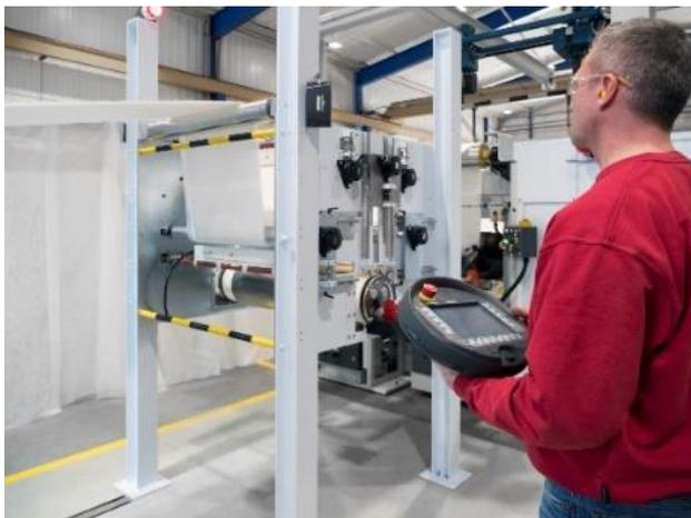
**Bildunterschrift:** Die Elektrochargingeinheit von Oerlikon Nonwoven sorgt für eine höhere Filterabscheideleistung auch im EPA und HEPA Bereich.
