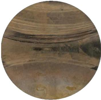
**Bildunterschrift:** Verschleißspuren an der Druckscheibe mit alter Anpresstechnik nach 24 h Laufzeit bei deaktivierter Druckscheibendrehung
