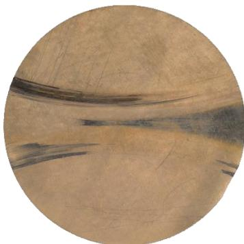
**Bildunterschrift:** Deutlich reduzierter Verschleiß an der Druckscheibe mit neuer Anpresstechnik nach 24 h Laufzeit bei deaktivierter Druckscheibendrehung
