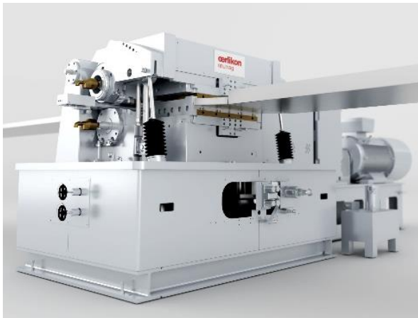
图片说明：欧瑞康纽马格 Baltic 卷曲机 - 新型压盘压紧系统可确保减少磨损
