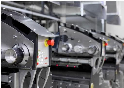
**Bildunterschrift:** Eine neue Antriebseinheit für WINGS POY reduziert im Aufspulbereich nochmals den Energieverbrauch um 3%.
