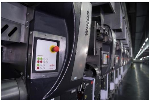
**Bildunterschrift:** Auch für die Verarbeitung von rPET Garnen einsetzbar: Oerlikon Barmag Spinnereikonzepte mit WINGS FDY.
