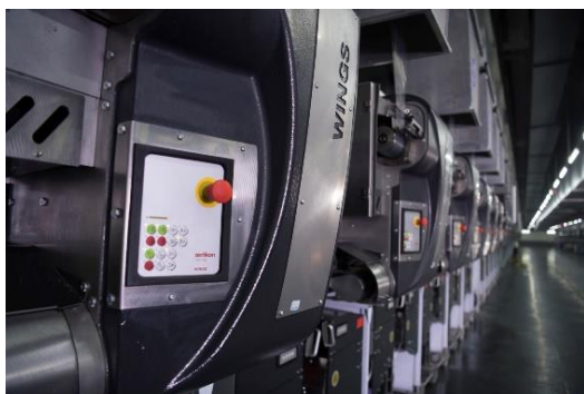
标题: 同样适用于再生聚酯长丝工艺: 欧瑞康巴马格 WINGS FDY 纺丝系统。
