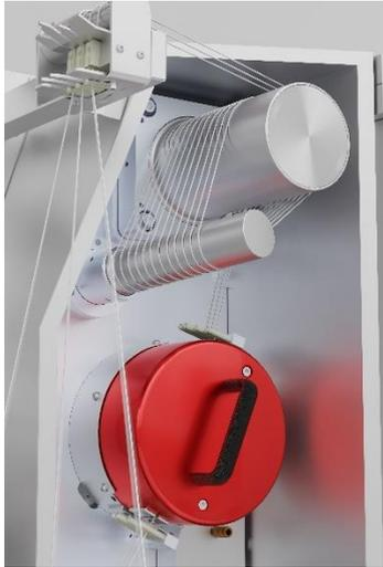
图片说明：采用 RoTac<sup>3</sup> 技术，即使在高速生产情况下，也可以比市场上其他交错装置更均匀地完成缠结。
