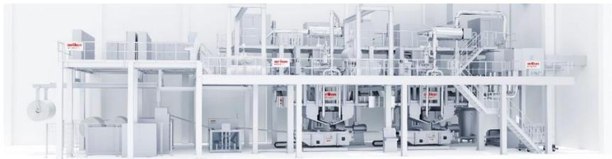
**Didascalìa:** impianto a doppia trave Oerlikon Nonwoven - in questo caso con ecuTEC+ integrato per caricare elettrostaticamente i mezzi.
