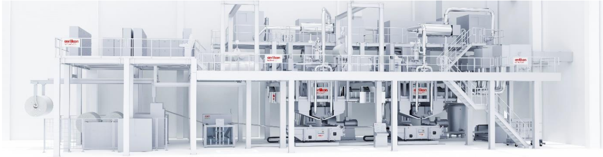
图片说明：双箱体设备 - 配备了内置的、对介质进行静电充电的 ecuTEC+单元。
