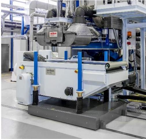
图片说明：欧瑞康纽马格的熔喷系统专用多功能成型台，占地面积和导线长度均大幅减少，从而降低维护成本。
