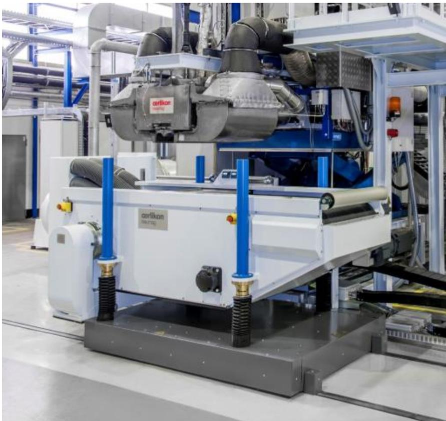
Bildunterschrift: Der multifunktionale Ablagetisch der Oerlikon Neumag für innovative Meltblown Anlagen. Er weist eine kompakte Bauweise und verkürzte Bandlänge vor, die zu geringeren Wartungskosten führen.
