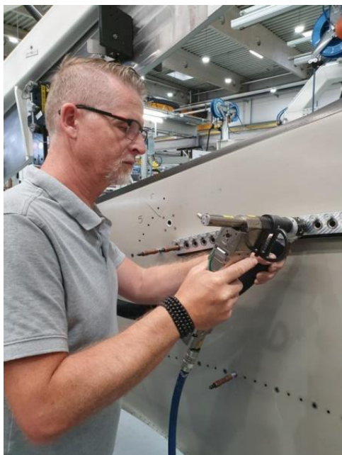
Rys. 4 Wysoce ścierna obróbka kompozytów stawia przed narzędziami ekstremalne wymagania. Rozwiązania dotyczące wiercenia opracowane przez C6 i Oerlikon Balzers sprawiają, że proces ten stał się wysoce opłacalny dzięki szybszej wymianie narzędzi i innym czasom procesu niż miało to miejsce wcześniej. / Obraz: FACC
