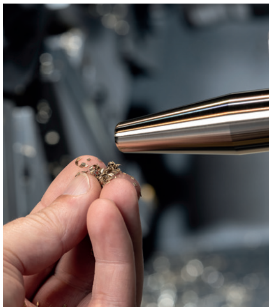
Perfekte Zerspanung von bleifreiem Messing mit BALINIT® HARD CARBON: Rico Fritzsche von Oerlikon Balzers und Vicente Madrid von Werkö (v.l.).
