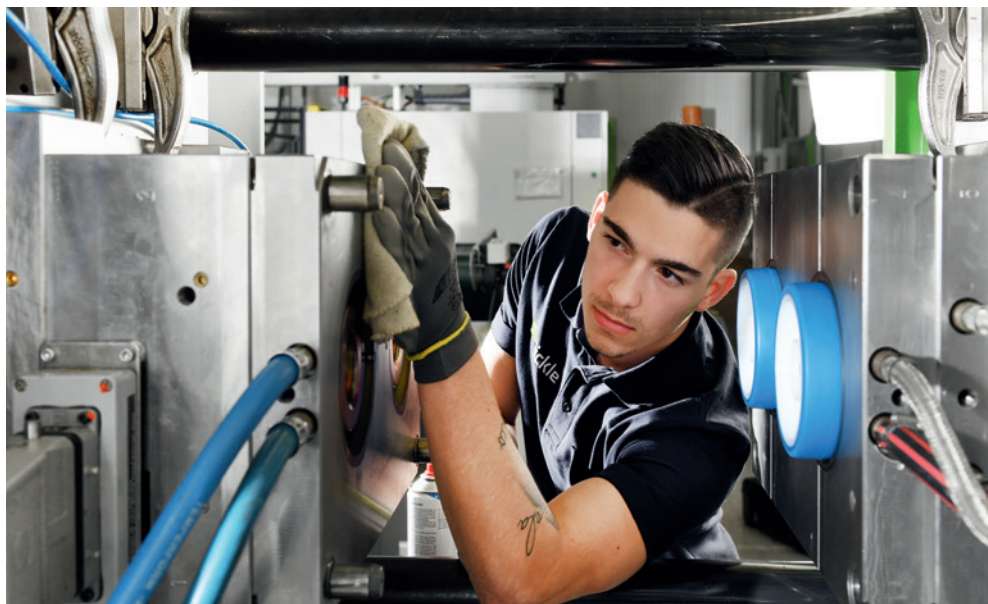
Blickle-Mitarbeiter Alessio Lonis kann Ablagerungen auf dem Spritzgusswerkzeug nun leicht entfernen – dank BALINIT® CROMA PLUS.
