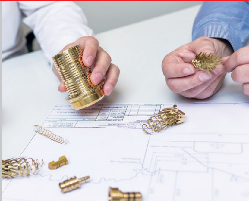
Bleifreies Messing ist extrem schwierig zu bearbeiten, wobei Band- oder Wirrspäne entstehen können.
