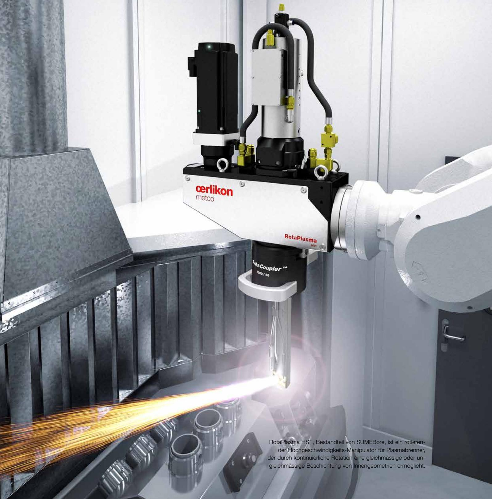
RotaPlasma HS1, Bestandteil von SUMEBore, ist ein rotierender Hochgeschwindigkeits-Manipulator für Plasmabrenner, der durch kontinuierliche Rotation eine gleichmässige oder ungleichmässige Beschichtung von Innengeometrien ermöglicht.
