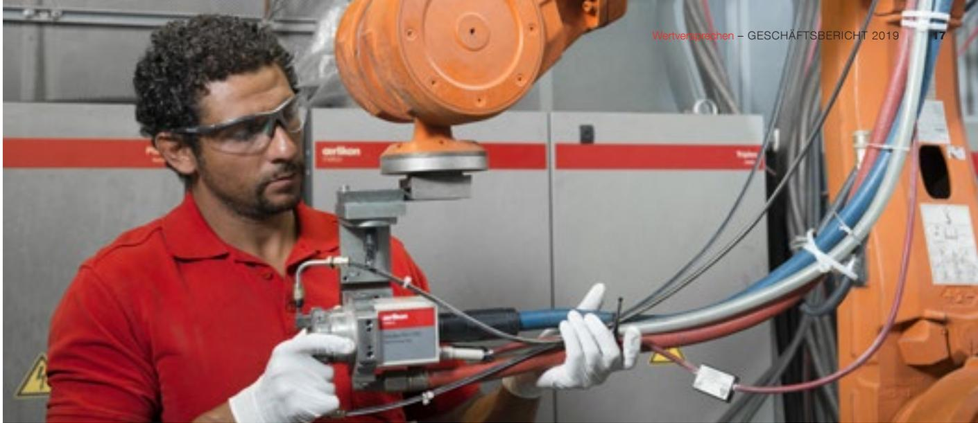
Die Plasmaspritzpistolen von Oerlikon Metco werden genau nach den Bedürfnissen der Kunden für thermische Spritzschichten konfiguriert.
