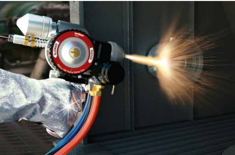
Trotz der robusten Bauart wiegt die Metco 16E Drahtflammspritzpistole nur 2,5 kg und ist somit bestens für den mobilen Einsatz geeignet – sogar für die knapp 140 Meter hohe und 680 Tonnen schwere Spitze des One World Trade Center.
