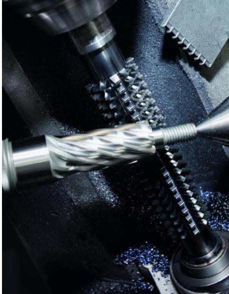
Beim Wälzfräsen lassen sich mit BALINIT ALTENSA nun noch höhere Schnittgeschwindigkeiten erzielen. / Bild: Oerlikon Balzers.
