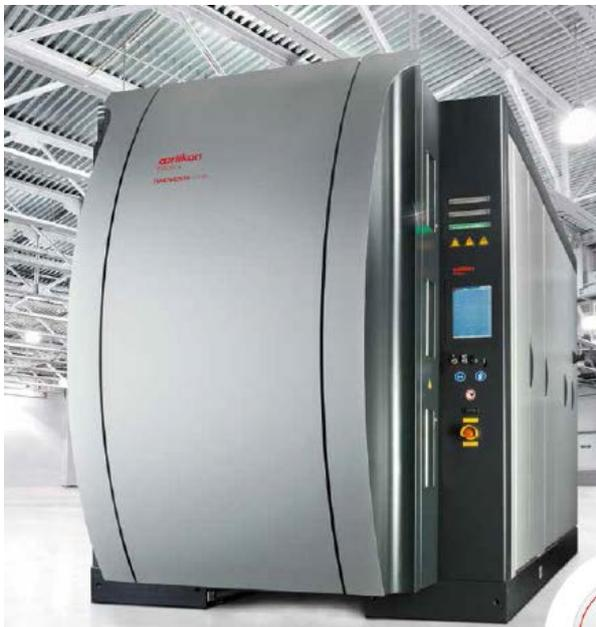
Mit ihrer Ladekapazität für Werkstücke mit einer Höhe von mehr als einem Meter, einem Drehdurchmesser von 96 cm und einem zulässigen Chargengewicht von bis zu 3'000 kg ist INNOVENTA mega eine ideale Plattform zur Beschichtung von großformatigen Formwerkzeugen oder Sägeblättern.
