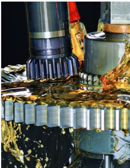
Beim Wälzstoßen mit HSS-Schneidrädern spielt BALINIT ALTENSA vor allem seine extreme Festigkeit gegen Abrasivverschleiß aus. / Bild: Oerlikon Balzers.
