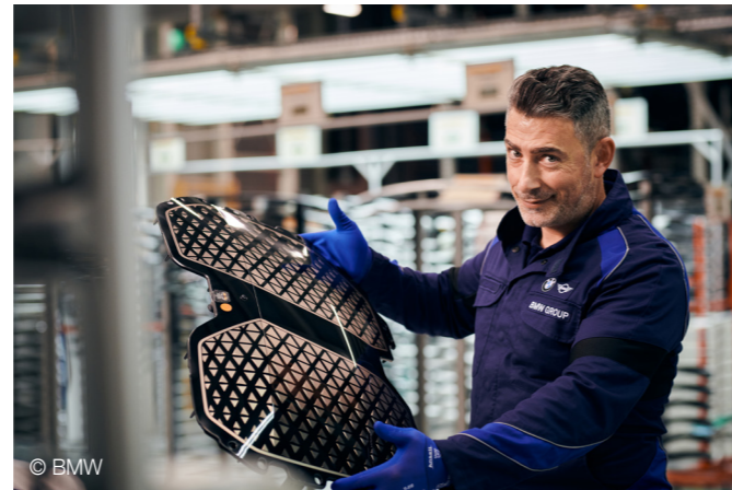
Die metallisierte Beschichtung der Niere des vollelektrischen BMW iX ermöglicht die Integration von Sensoren, z.B. zur Messung des Abstands zum vorausfahrenden Fahrzeug.
