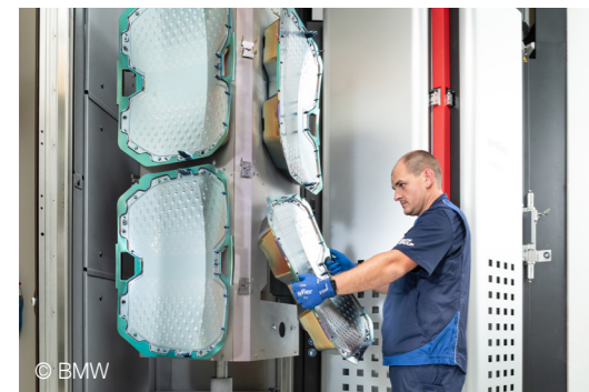
© BMW Ein Mitarbeiter des BMW Werks Landshut bestückt die INUBIA B15 mit Nieren des BMW iX.
