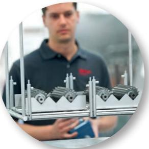
クリーンな表面はコーティングの密着に必要不可欠です。そのためエリコンバルザースは、PVDのための表面前処理準備に相当量の努力と投資を行い、環境に悪影響を与えない水性アルカリバスを使用した、複数ステージの超音波洗浄ラインを提供します。
