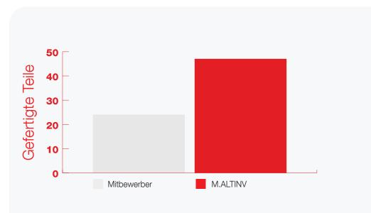
Benchmark-Test für Gewindebohrer M8 mit 15 m/min bei C45 Stahl, durchgeführt von einem großen Werkzeughersteller
