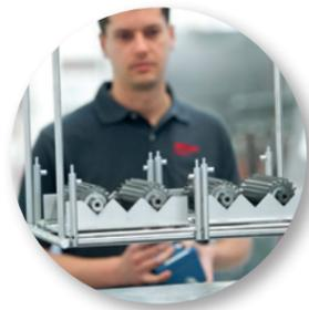
Saubere Oberflächen sind wichtig für die Schichthaftung. Daher widmet sich Oerlikon Balzers bei PVD-Beschichtungen intensiv der Oberflächenaufbereitung und bietet mehrstufige Ultraschallreinigungslinien auf Basis von wasserhaltigen Laugenbädern ohne umweltschädliche Zusätze an.
