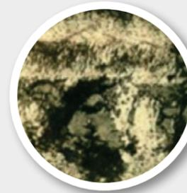
La trace d'usure (30x) de la bague nitrurée montre une forte éraillure au-delà de 150 m de glissement.
