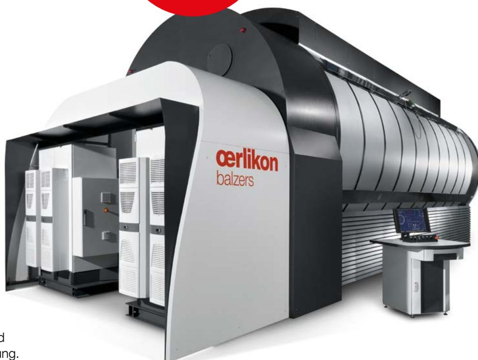
BALITHERM® PPD kommt in der INAURA Beschichtungsanlage zum Einsatz. Diese verfügt über eine Beladungskapazität von 10 x 3 Metern und 40 Tonnen. Der vollautomatisierte PPD®-Prozess sorgt für eine stabile und kontrollierte Verschleißschutz-Behandlung. Dank der Kombination aus Wasserstoff, Stickstoff und Elektrizität kommt PPD® ohne Verwendung giftiger Gase und Chemikalien aus.
