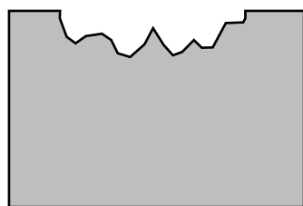
erozja i ścieranie
