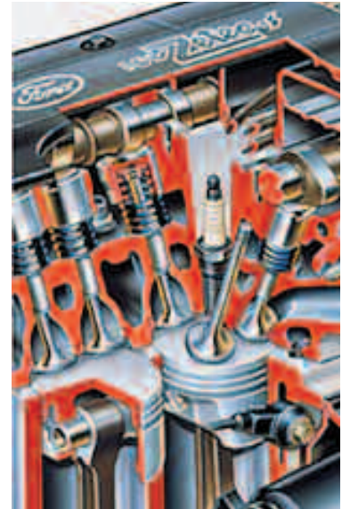
Die Beschichtung von Motorenteilen reduziert die Reibung und steigert dadurch Leistung und Effizienz der Antriebsaggregate.
