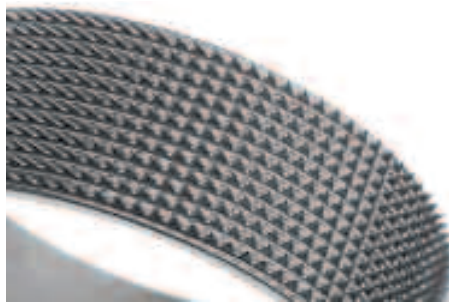
Auflösewalze einer Rotorspinnmaschine mit BALINIT® CNI-Beschichtung
