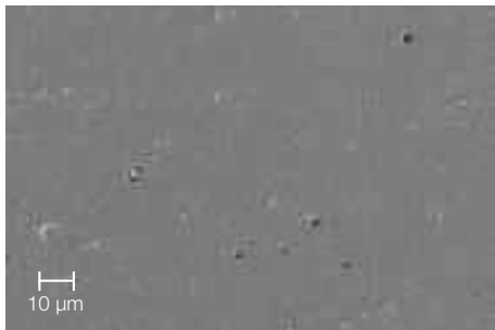
Oberfläche einer PVD-Arc-Schicht mit Nachbehandlung.
