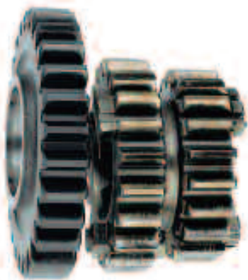
Zahnradern eines Motorradstirnradgetriebes nach Ölverlust: BALINIT® C (WC/C)-beschichtet (links), unbeschichtet (rechts)
