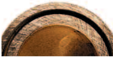
Bronze: Abrasivverschleiß und Verformung
