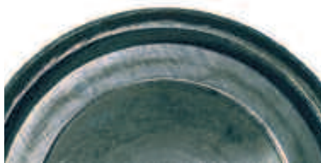
Stahl und BALINIT® C (WC/C): Verschleiß < 1 µm
