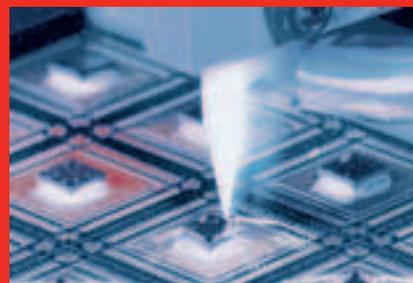
Die neueste Entwicklung von Oerlikon Esec, der Wire Bonder 3200, ist die zurzeit schnellste und präziseste Maschine für die Verdrahtung von Rohchips in der Halbleiterindustrie.
