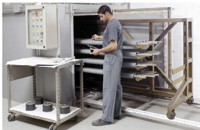
Ofenbehandlung zum Vernetzen der Polymerschicht
