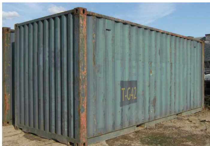
Korrosion durch Witterungseinflüsse
