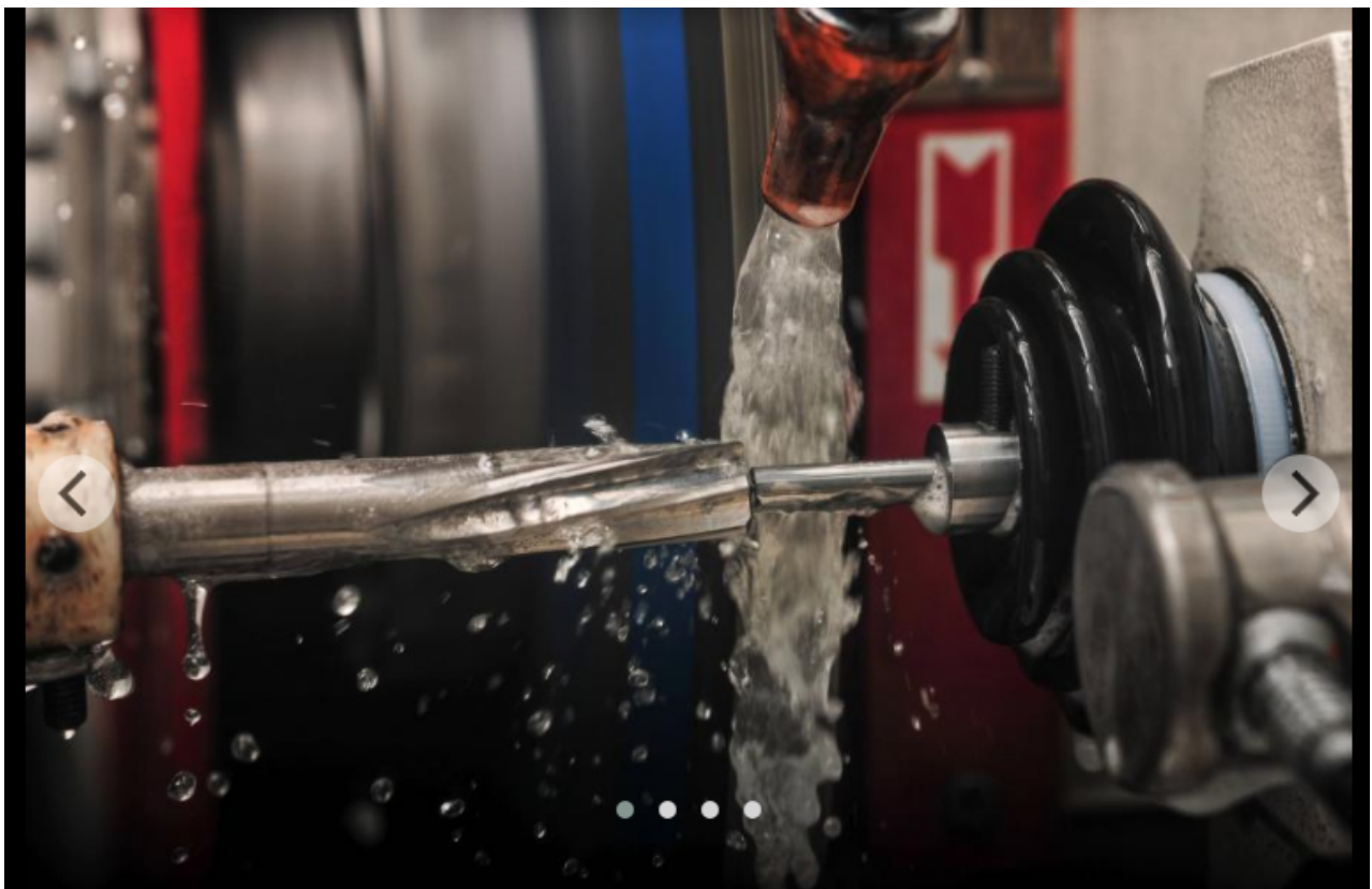
Bei der Fertigung von Reibahlen zählen für Urbschat-Tools drei Dinge: Präzision, Liefertempo – und eine Beschichtung wie Baliq für spezielle Fälle. Foto: Oerlikon Balzers
