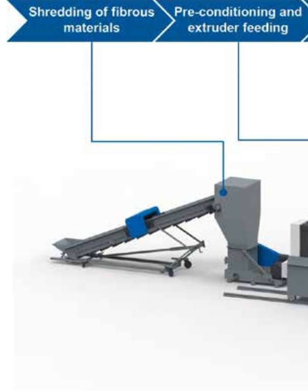
Bağlı VarioFil eğirme hattı ile VacuFil Visco+ inline elyafattan elyafa geri dönüşüm hattının işlem adımları.
